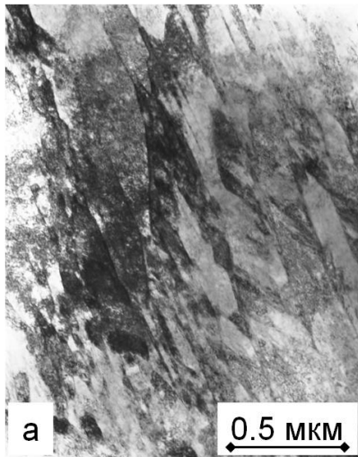
Рисунок 3.20 -Микроструктура образца №2 стали 20Х15АНЗМД2: а – микроструктура мартенсита; б – темнопольное изображение в рефлексе (200) - \alpha мартенсита.
